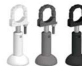
Позволяют закрепить радиатор за нижний коллектор и обеспечить прочное и надежное крепление к полу. Рекомендованы к применению в тех случаях, когда настенный монтаж невозможен, у панорамных окон или легких перегородок.
