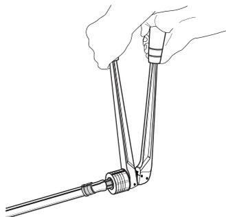
4. Насадить трубу на фитинг до последнего зубца штуцера. Насаживать фитинг до упора не рекомендуется, так как соответствующая глубина обеспечивается расширением. Маркировка глубины насаживания не требуется.
