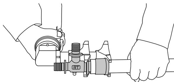
Рисунок 7. Пресс-инструмент
