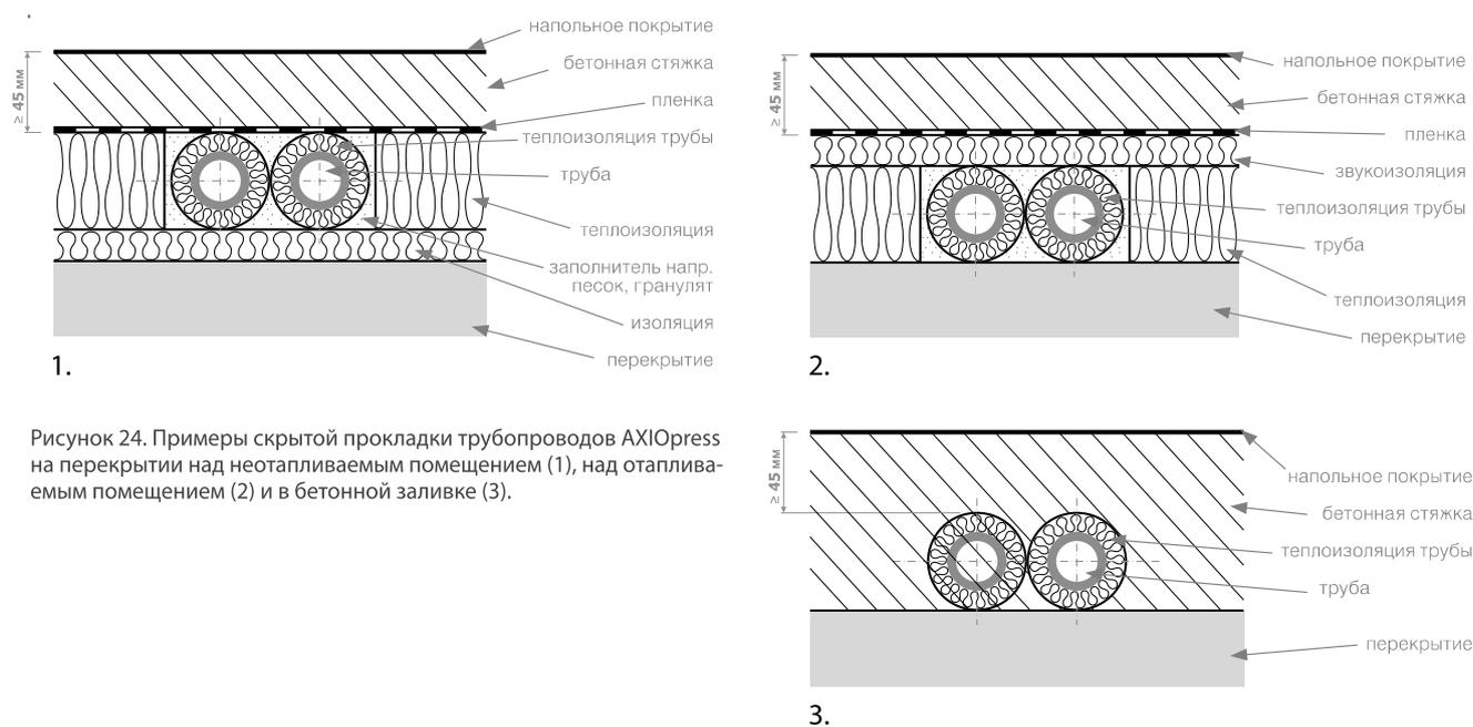
Рисунок 24. Примеры скрытой прокладки трубопроводов AXIOpress на перекрытии над неотапливаемым помещением (1), над отапливаемым помещением (2) и в бетонной заливке (3).
