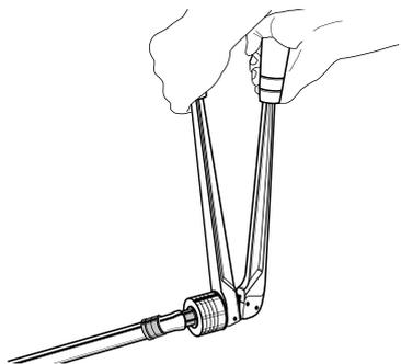
Установить в ручной инструмент расширительную головку соответствующего размера, надвинуть конец трубы до упора на расширительную головку, после чего расширить её. Затем трубу повернуть на четверть оборота и расширить ещё раз.
