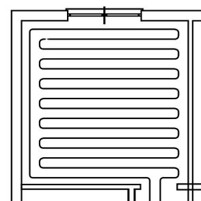
Рисунок 52. Пример укладки труб с постоянным шагом.
