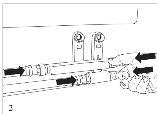
3. Определить необходимую длину присоединительных трубок и произвести их обрезку. Надвинуть соединения с обжимными кольцами на присоединительную трубку. Для подключения угловых трубок к крестовине, в комплект включены резьбозажимные соединения. Для присоединения трубки к прибору необходимо учитывать:
