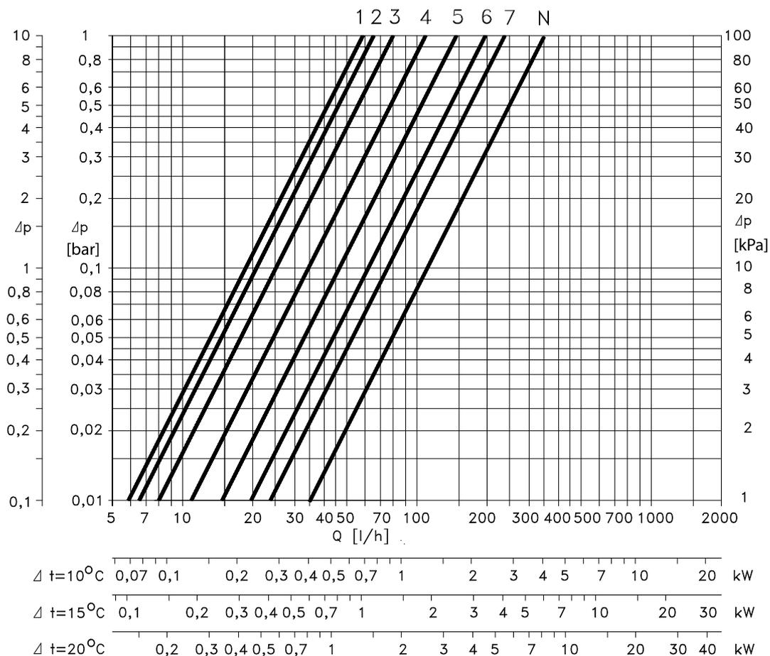
Диаграмма для определения предварительной настройки клапана RA-U 013G1383 с установленным термозлементом серии RA 2000 при  $\Delta t = 2^\circ\text{C}$
