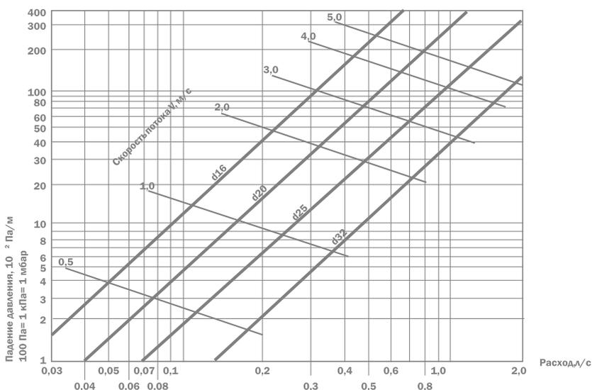
Рисунок 20. Номограмма потерь давления для труб PE-Xb в системе отопления
