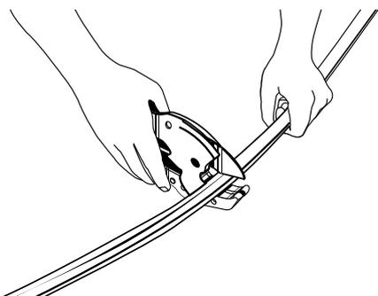
Трубу обрезать труборезными ножницами под прямым углом.
