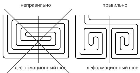
Рисунок 44. Пересечение деформационного шва
