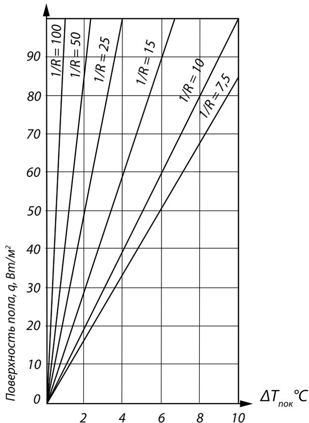
Рисунок 59. График понижения температуры через покрытие пола.
