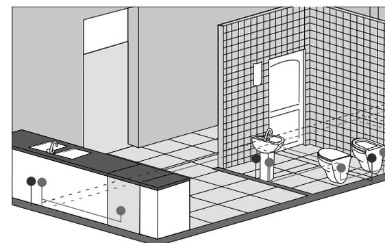
Рисунок 28. Пример разводки тройниками в системах отопления и водоснабжения
