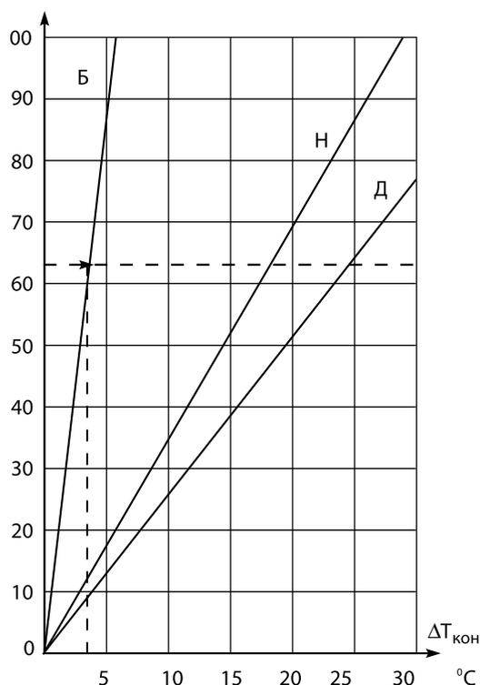
Рисунок 60. График понижения температуры в различных конструкциях пола.
