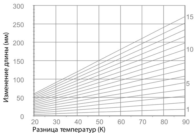
Рисунок 10. Линейное удлинение длины труб AXIOpress: PE-Xb, PE-Xb EVONH
