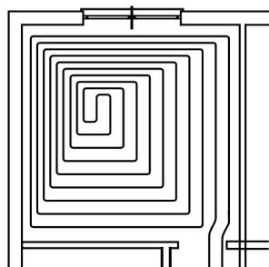
Рисунок 51. Пример укладки труб с переменным шагом.
