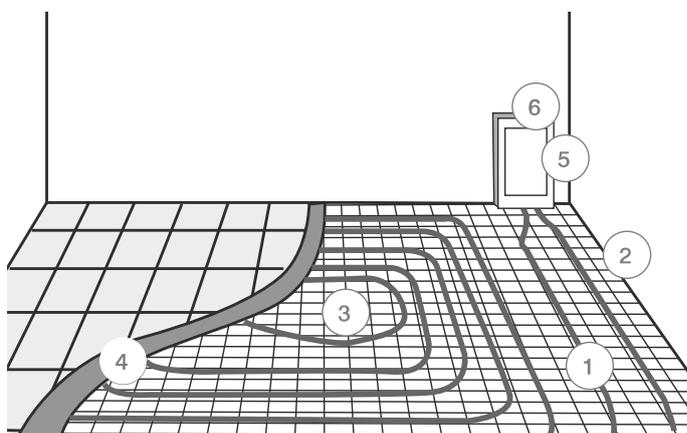
Рисунок 41. Схема системы напольного отопления:
