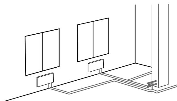
Рисунок 29. Пример смешанной разводки в системах отопления
