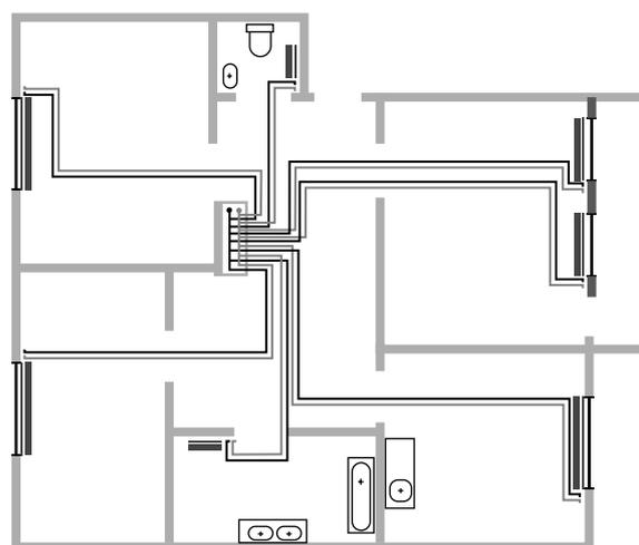
Рисунок 34. Схема подключения в двухтрубной системе с распределительным коллектором.
