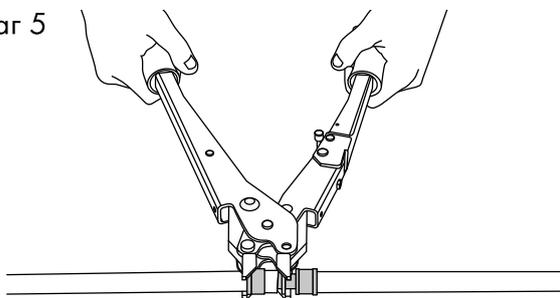
В зависимости от диаметра соединения следует выбрать соответствующие маркированные насадки. Зафиксировать насадки в гнездах ручного инструмента для запрессовки. Развести насадки, вложить фитинг и пресс-штулку в головку и запрессовать пресс-штулку до фитинга. Не допускать перекоса инструмента относительно соединения. Инструмент должен устанавливаться ровно и под прямым углом без перекосов относительно оси трубы.
