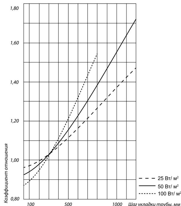
Рисунок 57. График зависимости температуры теплоносителей от шага укладки.
