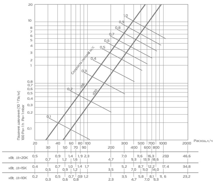
Рисунок 21. Номограмма потерь давления для труб PE-Xb водоснабжения
